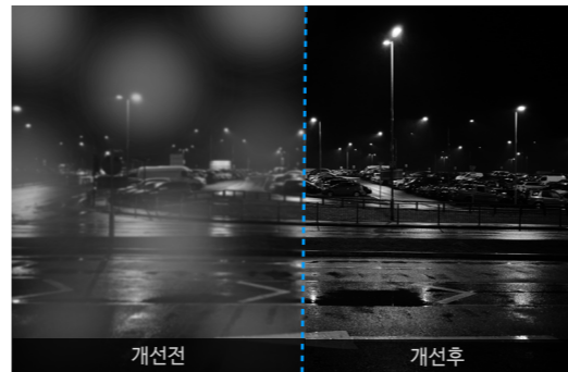
렌즈와 IR을 분리한 구조개선으로 야간 난반사 차단 IR과 렌즈를 분리한 디자인으로 난반사를 완벽하게 차단하였습니다.
